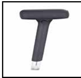
Armlehne B: Höhen- (100 mm), breiten- (35 mm), tiefenverstellbar ( \pm 50 mm) und schwenkbar ( 30^\circ ) mit weicher Leder-Auflage und polierten Aluminium-Trägern
